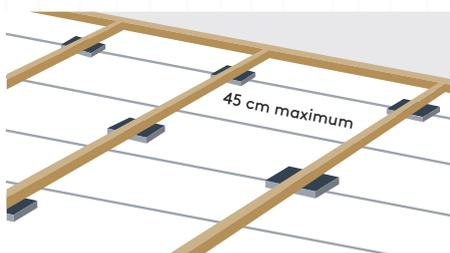
Ne pas espacer les lambourdes de plus de 45 cm. Il est conseillé d'installer des cales sous les lambourdes afin de garantir la planéité de l'ossature.
